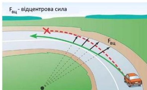
Рисунок 3 – Залежність відцентрової сили від радіусу повороту
